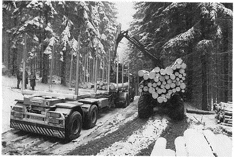
Direktverladung vom Rückezug auf den Sattel. In Brilon weichten tagelange Regen- und Schneefälle die Wege auf, so daß vorsorglich gar nicht erst abgesattelt wurde.
