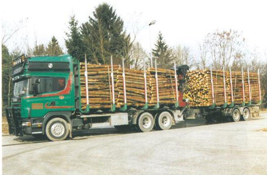
Der neue Kurzholz-Lkw der Firma Richter aus Gersthofen. Sechs Stöße mit jeweils zwei Meter langem Holz sind längs geladen.
