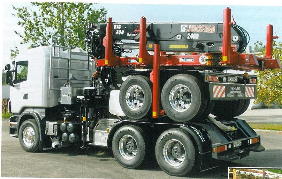
**(eb).** Seinen ersten Kombizug stellte Huttner Fahrzeugbau auf der Interforst 2002 vor. Damals mußte der Nachläufer jedoch noch frei hochgehoben werden. Bei der jetzt vorgestellten Weiterentwicklung bildet ein Zwangslenker-Aufbau die Basis.
