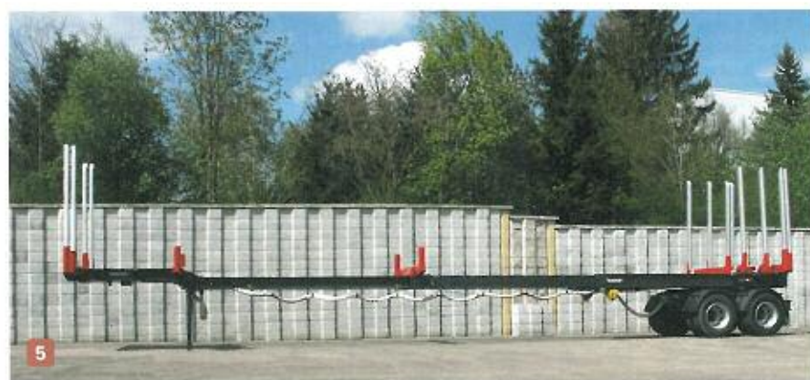
Abb. 5: Huttner Sattelaufleger Typ SAR-32/2Z-2A ausgezogen für den Langholztransport
