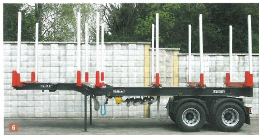
Abb. 6: Huttner Sattelaufleger Typ SAR-32/2Z-2A in Stellung Leerfahrt
