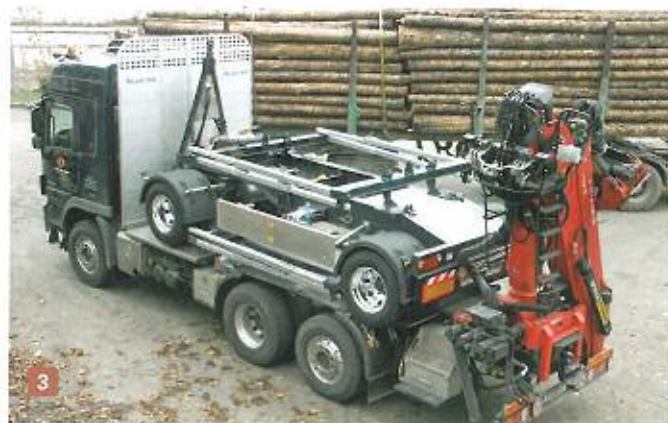
Abb. 2: Huttner-Kurzholzanhänger in Leichtbauweise mit einem Eigengewicht unter 2500 kg
