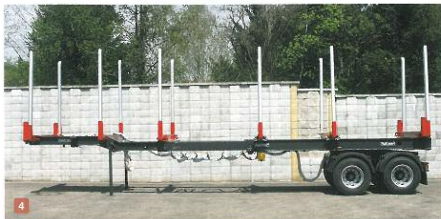
Abb. 4: Huttner Sattelaufleger Typ SAR-32/2Z-2A ausgezogen für 3x4 m Holz
