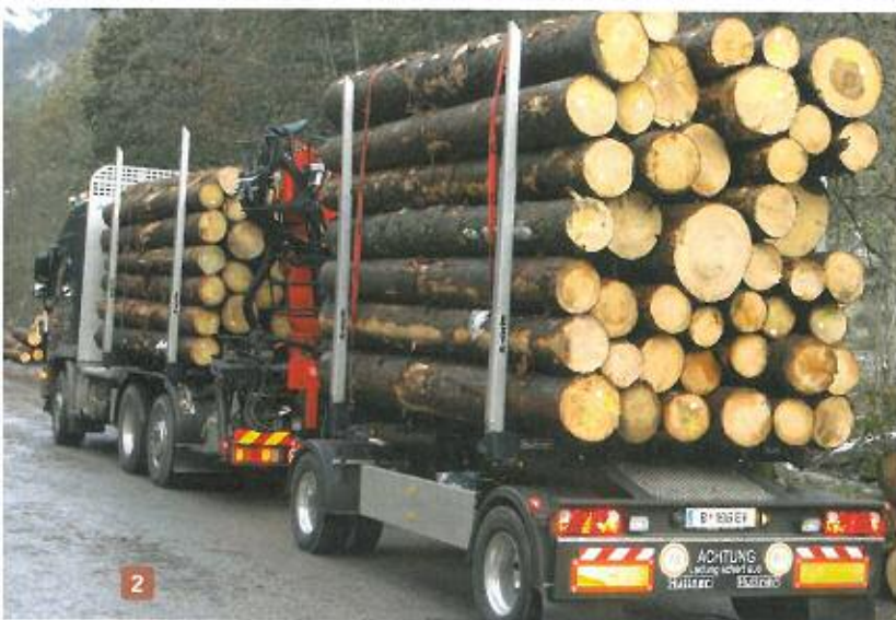
Abb. 2: Huttner-Kurzholzanhänger in Leichtbauweise mit einem Eigengewicht unter 2500 kg
