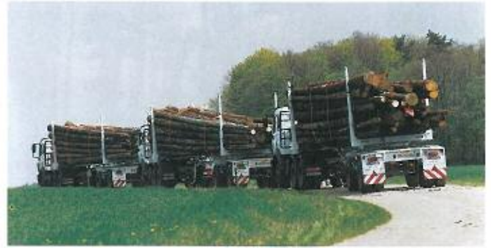
Langholz-Ferntransporte mit leichten Zügen ohne Ladekran. Im Bild das Huttner-System TuN - Tag und Nacht.
