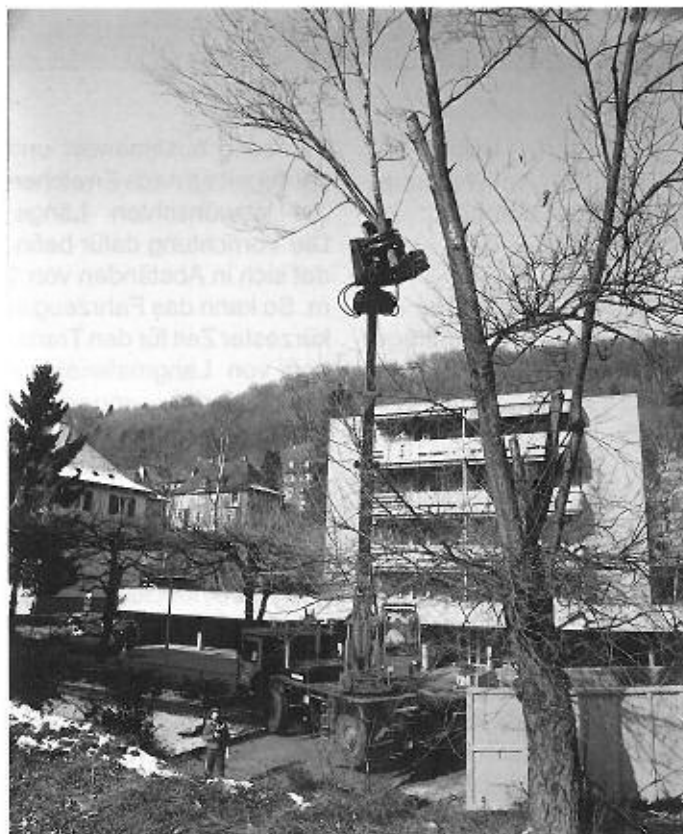
Die Auslegerspitze trägt einen drehbaren Greif- und Sägekopf. Unterhalb des Greifers wird der Baumteil abgetrennt.
