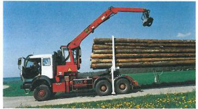
Ladefahrzeug beim Abstellen der Langholzladung mit dem Huttner-Ladeschemel Typ SLR-16/2TuN.
