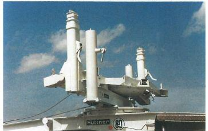
Kernstück des Huttner-Wechselsystems ist der Ladeschemel TYP -SLR/2 TuN mit abklappbaren Stützbeinen. Der Lkw-Ladeschemel kann bei Leerfahrt auf dem Anhänger-Ladeschemel mittransportiert werden.
