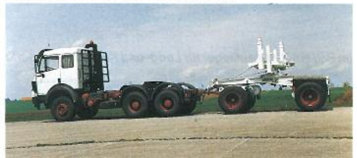
Es sieht zwar nicht so aus, aber das Bild zeigt einen kompletten Langholzzug. Gegenüber der traditionellen Ausführung mit Ladekran und Protzvorrichtung bietet dieser Zug ca. 4,5 to mehr Nutzlast.
