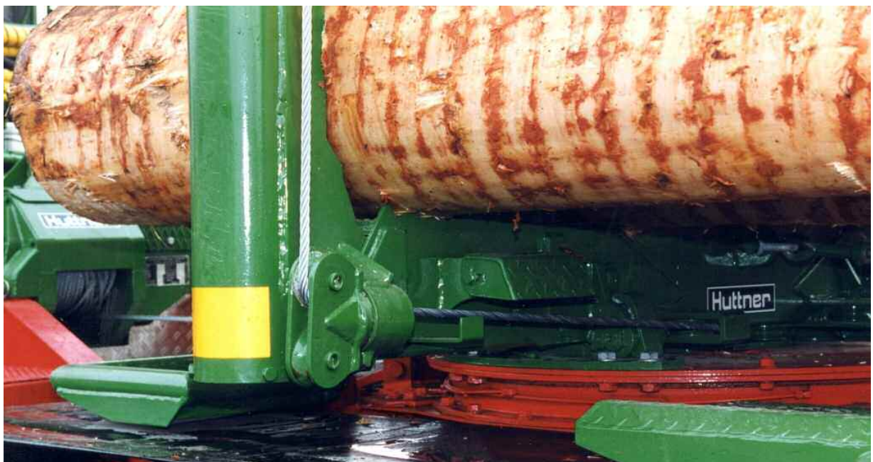
Seilrollenanlage zur Ladungssicherung mit Hydr. Winde
