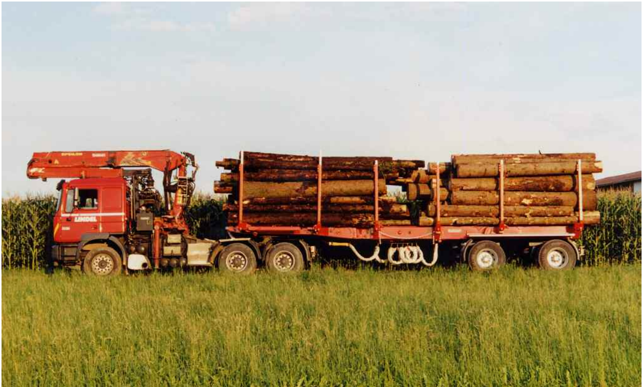
Auf Zuglänge 16,50 m gestellt zum Transport von Abschnitten
